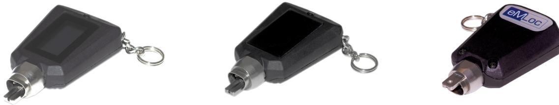
Der Designschlüssel mit wiederaufladbarer Batterie versorgt die Schließungen während des Öffnungs- und Schließvorgangs mit Energie, um die Zutrittsberechtigung zu überprüfen und im Falle eines berechtigten Zutritts die Schließungen betätigen zu können. Die Programmierung des Schlüssels erfolgt mittels eines BLE 4.0- oder NFC-fähigen Smartphones, einem Türmanager oder mit einem Bluetooth/NFC Programmiergerät.
