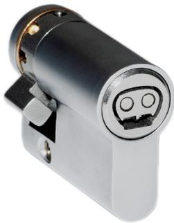
Mechatronischer Schließzylinder mit gekapselter Elektronikbaugruppe nach DIN EN 15684 / DIN 18252 / EN 1303 für den Einbau in Europrofilenschlössern nach DIN 18251. Wartungsarm durch kontaktbasierte Spannungsversorgung bei Betätigung mit dem Schlüssel.
