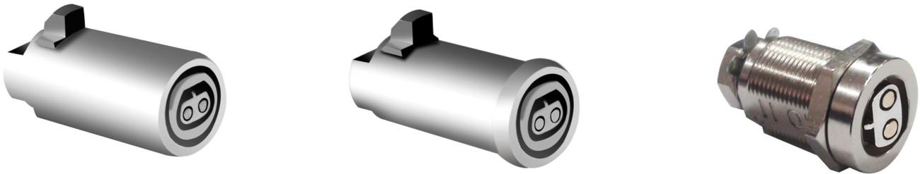
Mechatronische Kompakt-Schließzylinder mit gekapselter Elektronikbaugruppe für den Einsatz in gesicherten Automaten oder Vitrinen. Diese mechatronischen Schließzylinder arbeiten batterieles und sind somit wartungsarm. Die Spannungsversorgung erfolgt kontaktbasiert durch den Schlüssel während der Betätigung.
