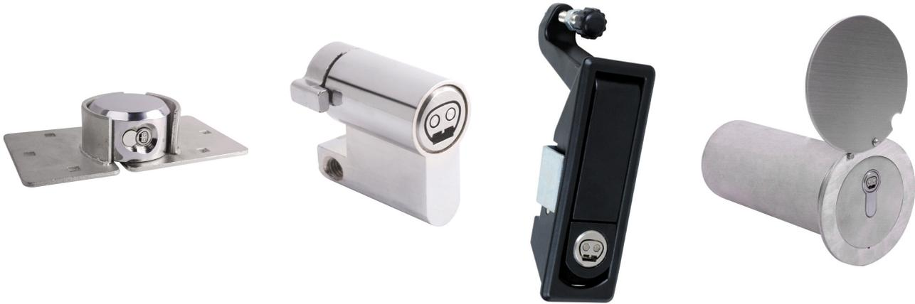
Mechatronische Zylinder und Schließungen für Spezialanwendungen mit gekapselter Elektronikbaugruppe. Diese mechatronischen Sonderlösungen mit integriertem Schließzylinder arbeiten batterieles und sind somit wartungsarm. Die Spannungsversorgung erfolgt kontaktbasiert durch den Schlüssel, während der Betätigung.
